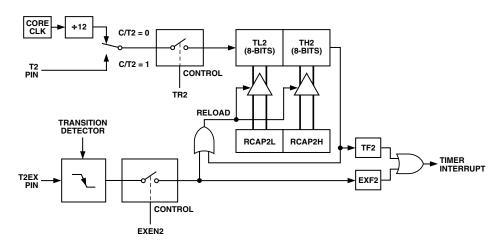
Figure 30. Timer/Counter 2, 16-Bit Autoreload Mode
